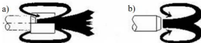
图 6.2-3 烟气内循环示意图 (a.再循环罩, b.射流卷吸)
